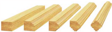
Рис.1 Поэтапная обработка кромок заготовленных брусков.
