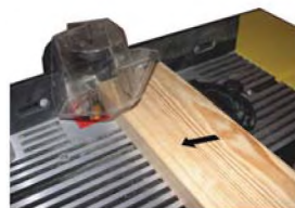
поперечное фрезерование (поперек волокон)
