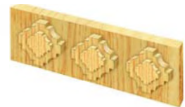
Рис.3 Наклеиваем декоративный орнамент на обрабатываемую поверхность. Можно использовать орнамент разных размеров и получить двухъярусную накладку маркетри.
