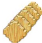
Рис.2 Обработанные бруски нарезать на пласти необходимой толщины (2-5мм).
