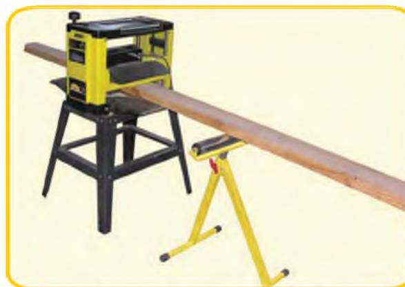
Пример использования роликовой опоры с рейсмусовым станком
