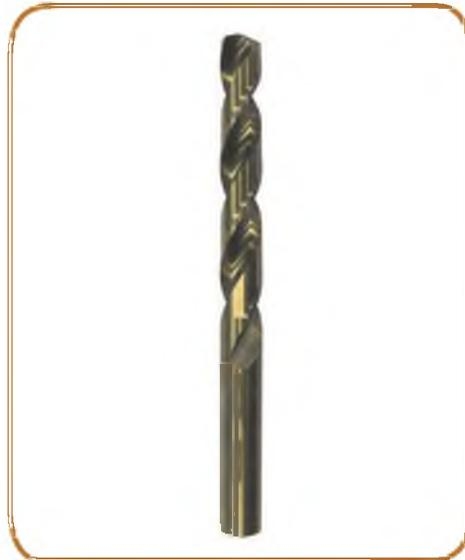
Свёрла Р6М5 от «Энкор» рассчитаны на профессионалов и требовательных пользователей. Они изготовлены из высокопроизводительной быстрорежущей стали с высоким содержанием вольфрама и молибдена. Поверхность свёрл отшлифована. Угол режущей части 135° в сочетании с крестообразной подточкой перемычки позволяет работать без предварительного кернения заготовки.
