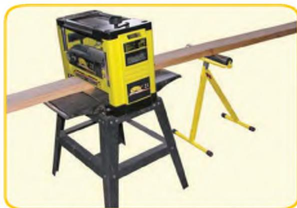
Пример использования роликовой опоры с рейсмусовым станком
