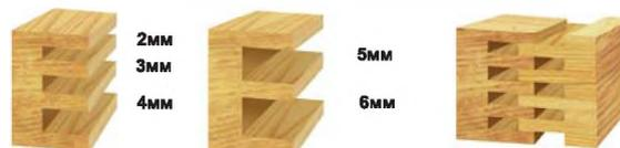
Фреза применяется для изготовления паза по кромке столярного изделия (столешниц, подоконников, элементов корпусной мебели) с целью крепления декоративных кромочных элементов, а также для изготовления шипового соединения.
