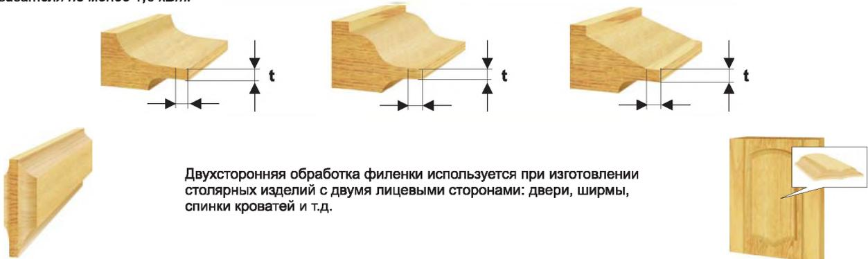
Двухсторонняя обработка филенки используется при изготовлении столярных изделий с двумя лицевыми сторонами: двери, ширмы, спинки кроватей и т.д.
