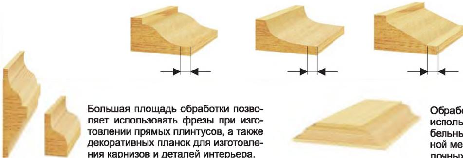
Большая площадь обработки позволяет использовать фрезы при изготовлении прямых плинтусов, а также декоративных планок для изготовления карнизов и деталей интерьера.
