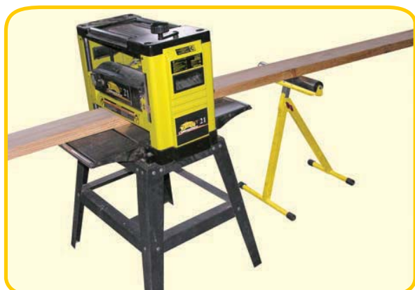
Пример использования роликовой опоры с рейсмусовым станком
