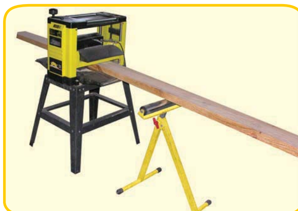
Пример использования роликовой опоры с рейсмусовым станком
